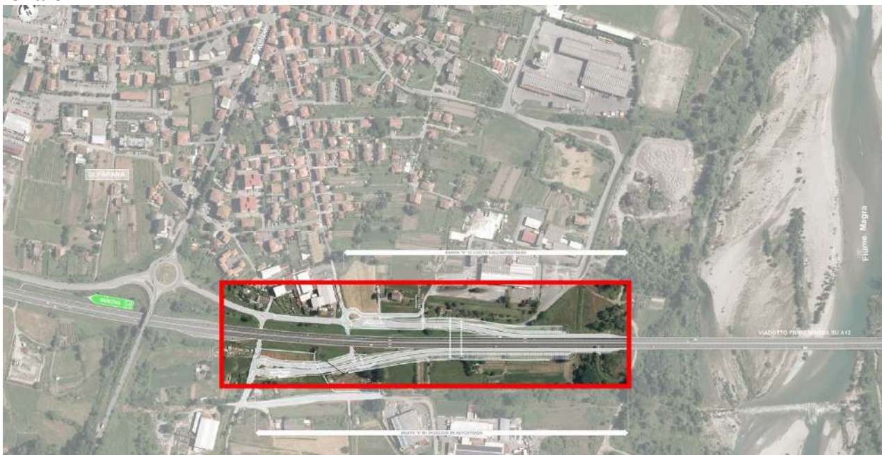
Figura 1b - Individuazione dell'area di realizzazione delle rampe dell'asse autostradale A12 da progetto SALT.
