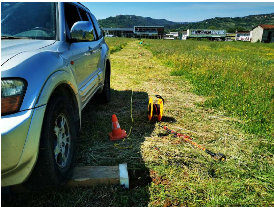
Indagine in sismica a rifrazione in onde Sh: energizzazione - Documentazione fotografica
