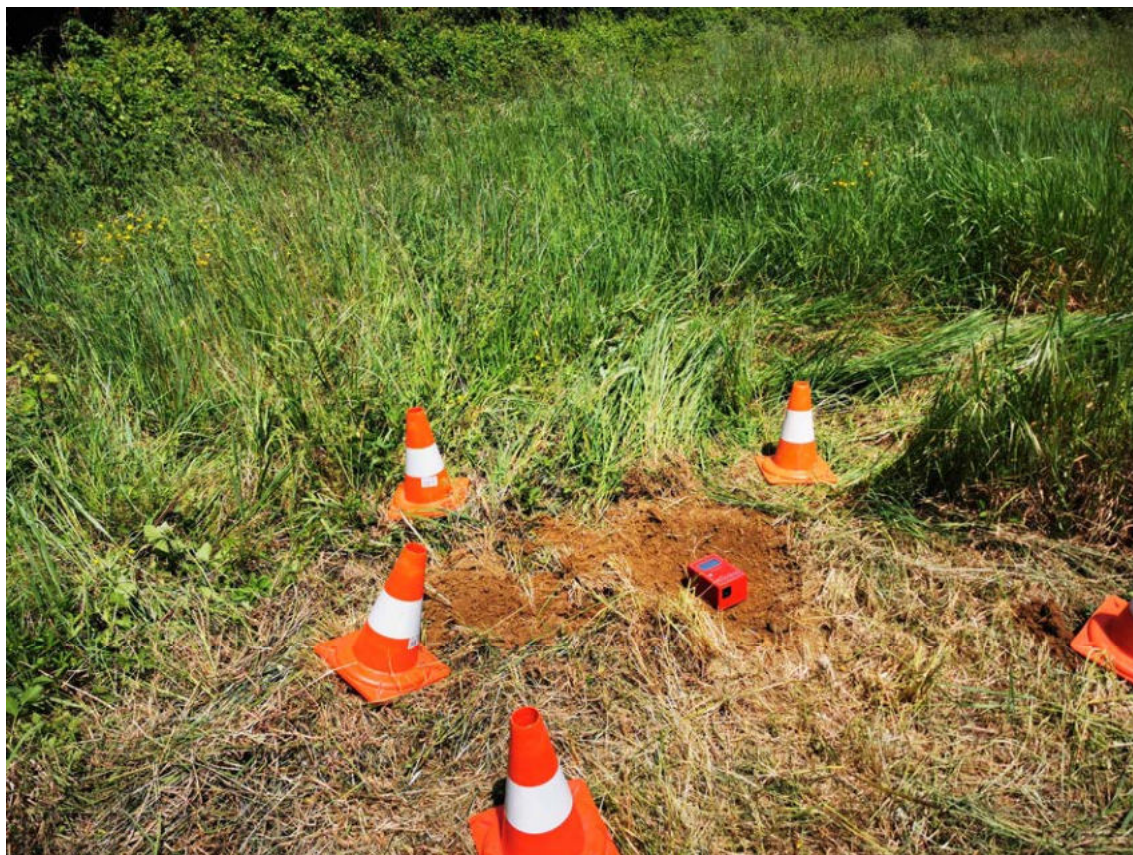
Indagine in sismica a passiva a stazione singola HVSR2 - Documentazione fotografica
